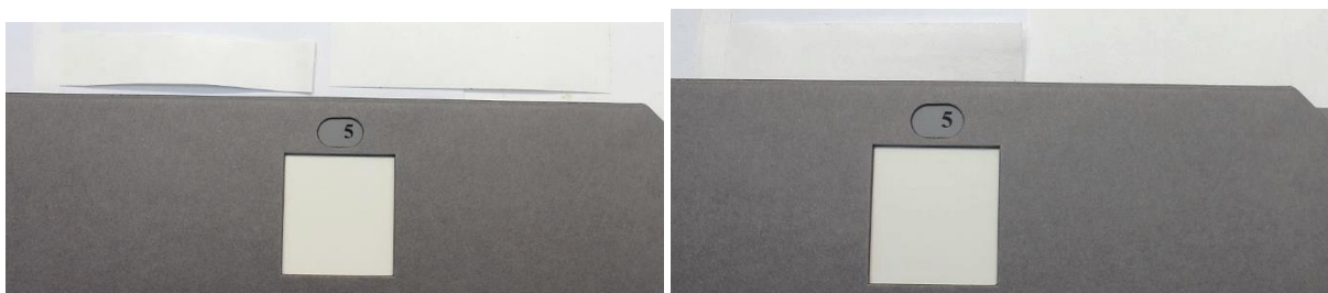
Abb. 4: 230416-P2.1 /P2.2 nach Prüfung mit Schweißsimulanz
