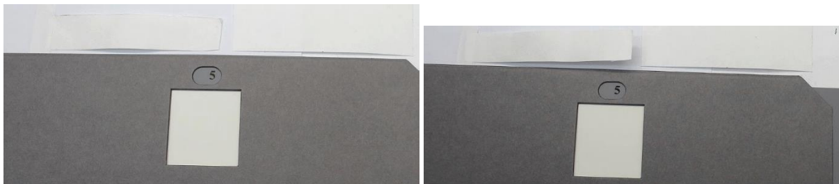
Abb. 2: 230416-P1.1 /P1.2 nach Prüfung mit Schweißsimulanz
