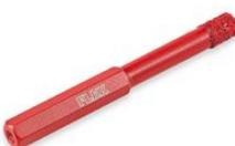
Zum Bohren ohne Wasser mit Akku-Bohrschraubern oder Bohrmaschinen. Bohrer mit Sechskant-Schaft zum Spannen in Bohrfutter. Die Multi-Diamantbeschichtung sorgt für hohe Standzeiten. Die Bohrer sind im Kern mit einem verfestigten Kühlmittel gefüllt, das bei der Bearbeitung durch Wärme schmilzt, dadurch entsteht eine Kühlwirkung. Zum Bohren von Dübellöchern in Feinsteinzeug (bis Härte 5), Granit, Marmor.
