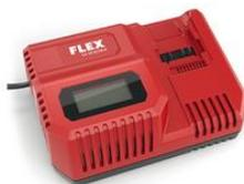
Zum Laden von 10,8 und 18,0 V Akkupacks. Mit großformatigem LCD Display für Batteriediagnostik und Ladezustand. Ladezeit: ca. 40 min für 18,0 V / 2,5 Ah und ca. 50 min für 18,0 V / 5,0 Ah. Durch ein spezielles Ladeverfahren werden 80% der Ladekapazität nach ca. 30 min erreicht. Mit integrierter Akkupackkühlung, Überhitzungs-, Entladungs- und Überlastschutz.
