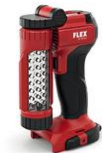
Leistungsstarke LED-Arbeitslampe mit 24 kalt-weissen LEDs und integriertem Entladungsschutz. LED-Kopf um 320° schwenkbar und um 180° klappbar. Schwenk- und versenkbarer Haken zum Aufhängen der Lampe und Gürtelclip. Leuchtdauer: ca. 20 Stunden mit Akkupack 2,5 Ah und ca. 40 Stunden mit Akkupack 5,0 Ah. FLEX Akku-System: Betrieb mit allen 18,0 V Akkupacks. Lieferung ohne Akku.
