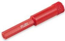
Zum Bohren ohne Wasser mit Akku-Bohrschraubern oder Bohrmaschinen. Bohrer mit Sechskant-Schaft zum Spannen in Bohrfutter. Die Multi-Diamantbeschichtung sorgt für hohe Standzeiten. Die Bohrer sind im Kern mit einem verfestigten Kühlmittel gefüllt, das bei der Bearbeitung durch Wärme schmilzt, dadurch entsteht eine Kühlwirkung. Zum Bohren von Dübellöchern in Feinsteinzeug (bis Härte 5), Granit, Marmor.
