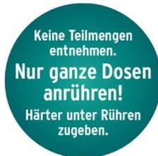
Das Material liegt im genau richtigen Mischungsverhältnis vor. Das Gebinde vom Stammlack von einzA LawiPur 2-K-PU Mattsiegel hat ausreichendes Volumen zur Aufnahme der gesamten Menge vom Härter für einzA LawiPur 2-K-PU Mattsiegel. Den Härter restlos in das Gebinde vom Stammlack leeren.
