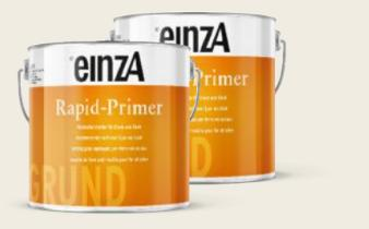
Schnelltrocknende, lösemittelhaltige, rostschützende Grundierung für Eisen und Stahl auf Spezial-Alkydharzbasis. Nitrobeständig; griffest nach ca. 15 Minuten, überspritzbar nach ca. 30 Minuten, überreichbar nach ca. 2 Stunden mit Alkydharzlacken.
