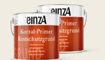
Rostschützender, blei- und chromatreier Haftgrund; Haftvermittler für NE-Metalle (außer Zink), Leicht- und Buntmetalle und duroplastische Kunststoffe; staubtrocken nach 2 Stunden, griffest nach 8 Stunden, überarbeitbar nach 16-24 Stunden.
