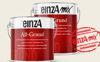
Schnelltrocknender Universal-Haftgrund mit guter Haftfestigkeit auf Zink, verzinktem Stahl, NE-Metallen, Leicht- und Buntmetall, Hart-PVC und duroplastischen Kunststoffen. Korrosionsschutz-Primer mit aktiven Rostschutzpigmenten für langlebigen Korrosionsschutz; staubtrocken nach 45 Minuten, griffest nach 1-2 Stunden, nach ca. 2-3 Stunden überarbeitbar mit Alkydharzlacken.
