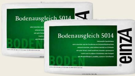
Ausgleichsmasse auf Alpha-Halhydratbasis zum Spachteln und Ausgleichen von Zement- und Calciumsulfatestrichen, Steinfliesen und Gussasphaltestrichen im Innenbereich von 1 bis 20 mm Schichtdicke in einem Arbeitsgang - ausgenommen sind Nass- und Feuchträume. Besonders geeignet auf Heizestrichen. **Farbe:** hellbeige
