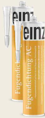
Elastoplastischer 1-Komponenten-Dichtstoff auf Acrylharz-Dispersionsbasis. einZA Fugendichtung AC wird in pastöser, standfester Form geliefert. Nach der Verarbeitung trocknet das Material durch Verdunsten des Wasseranteils zu einem elastoplastischen Dichtstoff. einZA Fugendichtung AC ist frostempfindlich. Zur Abdichtung von Fugen und Anschlüssen zwischen verschiedensten Baustoffen. Nach Durchtrocknung ist einZA Fugendichtung AC mit den einZA Lacken und Farben überstreichbar. **Farbe:** weiß
