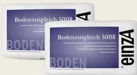
Diese zementäre Spachtel- und Nivelliermasse dient im Innenbereich zum Spachteln, Ausgleichen und Nivellieren von Estrichen, Schnellestrichen und Rohbetondecken. Ein Einsatz als Dünnestrich und Verbundausgleich auf Rohbetondecken und -sohlen ist ebenfalls möglich. Bei zu erwartenden Schichtdicken von 10 - 20 mm muss die Masse mit Sand der Körnung 0 bis 4 mm gestreckt werden. Auf Gussasphaltestrichen für Schichtdicken von 2 bis max. 5 mm geeignet.
