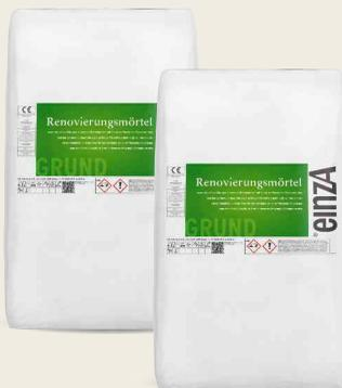
Wasserdampfdurchlässiger Kalkzement-Trockenmörtel mit Kunstharz-Zusatz und Faserarmierung. Zum Ausgleichen und Spachteln von tragfähigen Putzuntergründen und zum Vorbereiten eines tragfähigen Untergrundes für das Anbringen der einZA Wärmedämm-Systeme. Kann ohne Ribbildung bis zu 3 cm in einem Arbeitsgang aufgetragen werden. **Farbe:** grau
