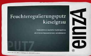
Werk trockenmörtel der der Mörtelgruppe CS II gemäß DIN EN 998-1 mit natürlichen Additiven für die spezifische Porengeometrie zur Anwendung im Innen-, Außen- und Sockelbereich. Zur dauerhaften Feuchteregulierung und Schaffung eines behaglichen Raumklimas in Innenräumen bei allen üblichen Arten von Mauerwerk von Alt- und Neubauten bei feuchten Untergründen.
