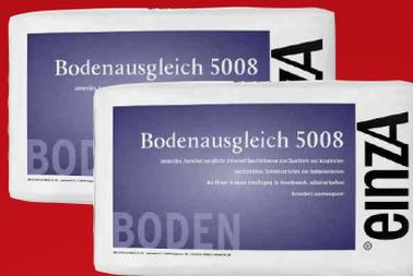
Diese zementäre Spachtel- und Nivelliermasse dient im Innenbereich zum Spachteln, Ausgleichen und Nivellieren von Estrichen, Schnellestrichen und Rohbetondecken. Ein Einsatz als Dünnestrich und Verbundausgleich auf Rohbetondecken und -sohlen ist ebenfalls möglich. Bei zu erwartenden Schichtdicken von 10 - 20 mm muss die Masse mit Sand der Körnung 0 bis 4 mm gestreckt werden. Auf Gussasphaltestrichen für Schichtdicken von 2 bis max. 5 mm geeignet.
