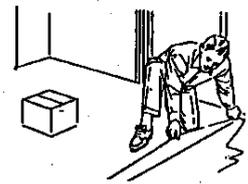
2. Beginnen Sie mit einer Testverlegung ausgehend vom Raummittelpunkt seitlichen hin zu beiden Wänden. Sollte der Wandanschluss weniger als 1/3 der Fliesenbreite betragen, dann verschieben Sie die gesamte Richtlinie um diese Fliesenbreite parallel zur Wand, um näher an der gegenüberliegenden Wand zu sein. Das verbessert das Aussehen des Fußbodens und verhindert das Anpassen von kleinen Randfliesen.
