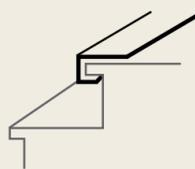
Aufgrund gewisser bauseitiger Gegebenheiten kann es erforderlich sein, dass eine TYP C Treppenkante über eine bestehende Treppennase geschoben werden soll. In diesen Fällen geben Sie uns bitte exakte Innenmaße für Höhe und Unterkante sowie TYP C-2 in der Aufmaßliste an.
